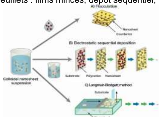
Figure 1. Vue schématique de différents processus de réassemblage de nanofeuillets inorganiques. [2a]
